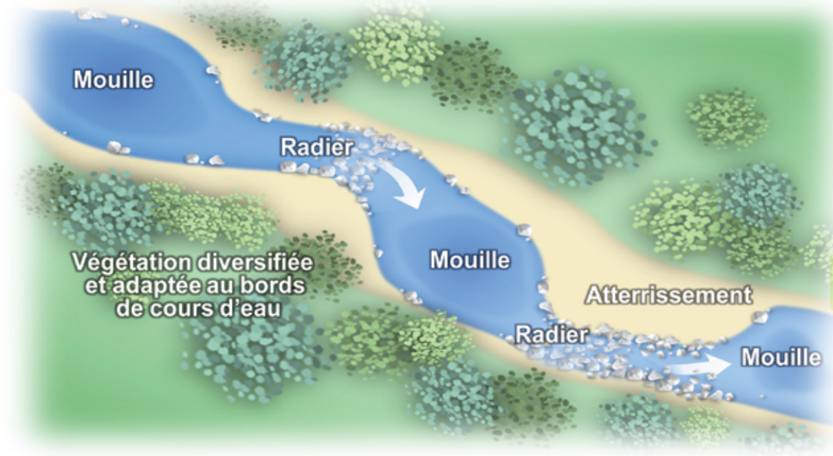
Après les travaux : cours d'eau sinueux et naturel
