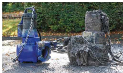
A gauche, une pompe normale, et à droite, une pompe qui s'est bloquée à cause des fibres des lingettes
